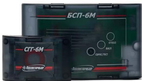
Предназначен для непрерывного автоматического контроля содержания природного и сжиженного газов. Выдачи световой и звуковой сигнализации в случае возникновения в помещении дозврывоопасных концентраций газов. Перекрытия газопровода быстродействующим электромагнитным клапаном.
